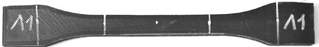
Рис. 1. Плоские образцы по ГОСТ 11262–2017, тип 1В
