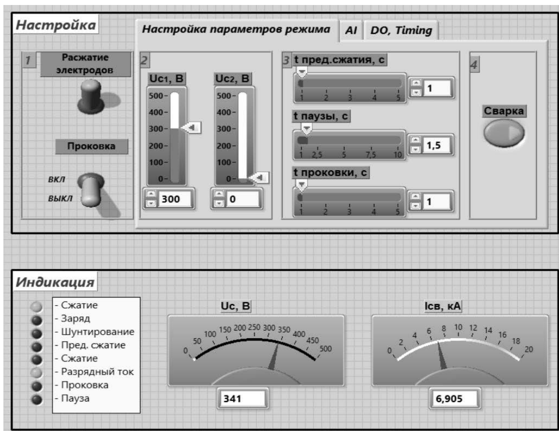
Рис. 3. Лицевая панель виртуального прибора системы управления
