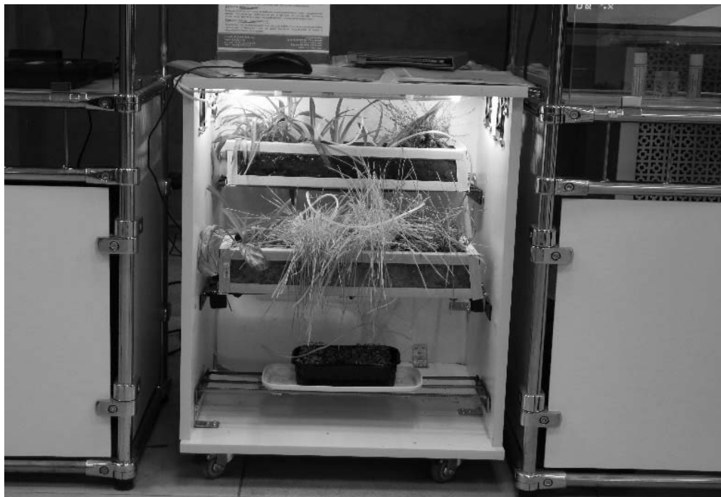
Рис. 4. Система вертикального озеленения на основе гидропоники
