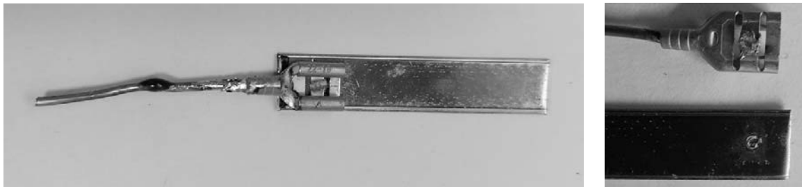
Рис. 5. Образец для испытания на прочность и вид образца после разрушения
