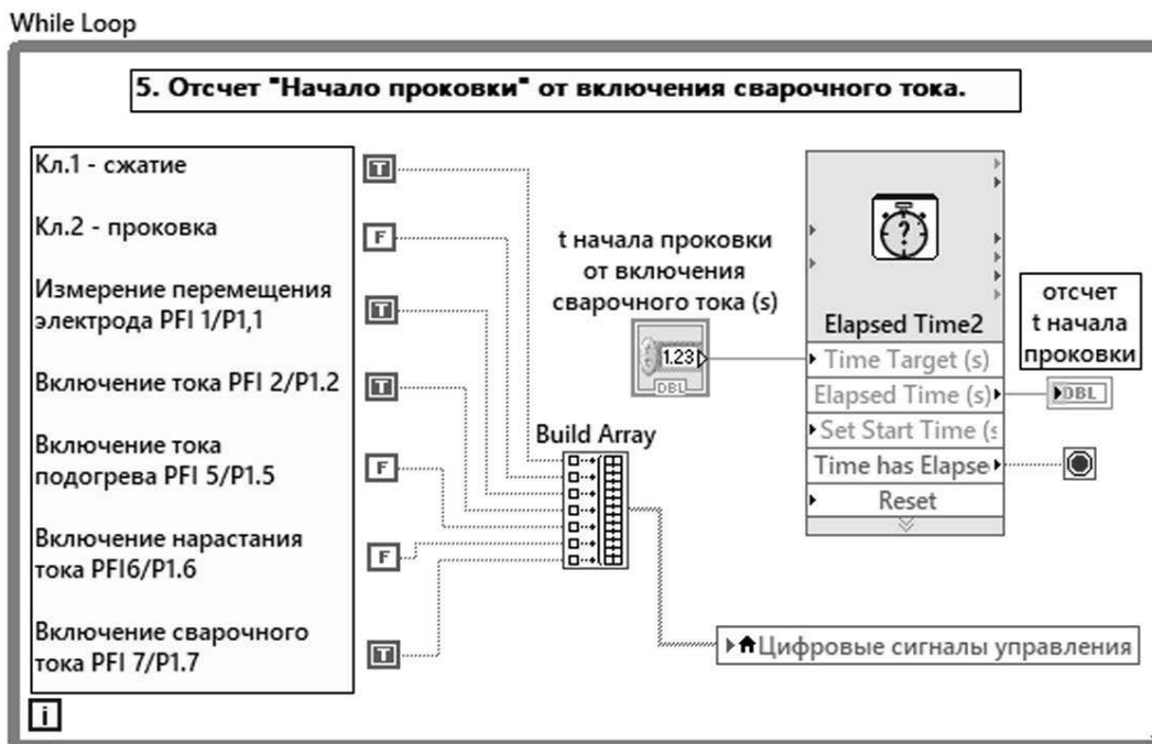
Рис. 6. Задание и отсчет времени начала включения повышенного усилия проковки от момента включения сварочного тока
