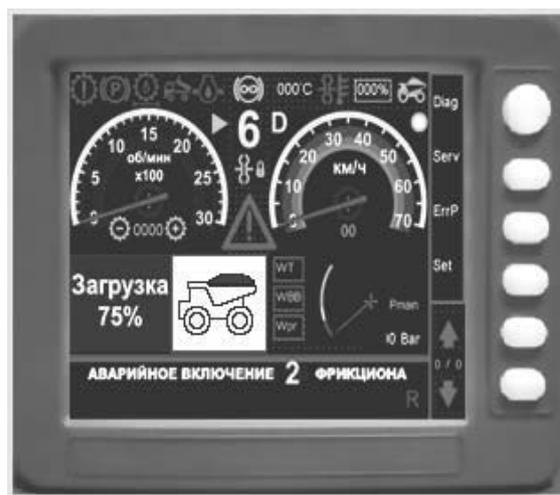
Рис. 3. Экраны просмотра экспертной диагностической системы ГМП
