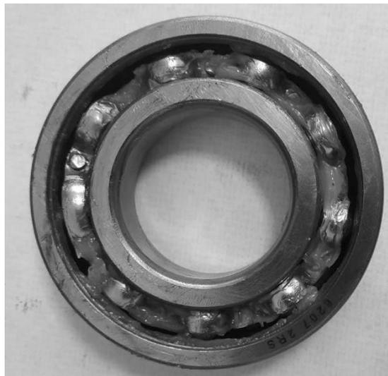
Рис. 2. Нанесенные дефекты на подшипники качения: а – лунка на дорожке качения наружного кольца; б – сломанное звено сепаратора
