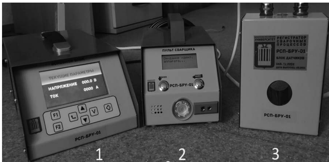
Рис. 2. Регистратор сварочных процессов РСП-БРУ-01: 1 – основной блок; 2 – пульт сварщика; 3 – блок датчиков
