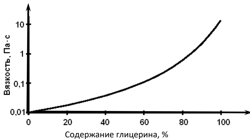
Рис. 4. Изменение динамической вязкости водного раствора глицерина в зависимости от концентрации
