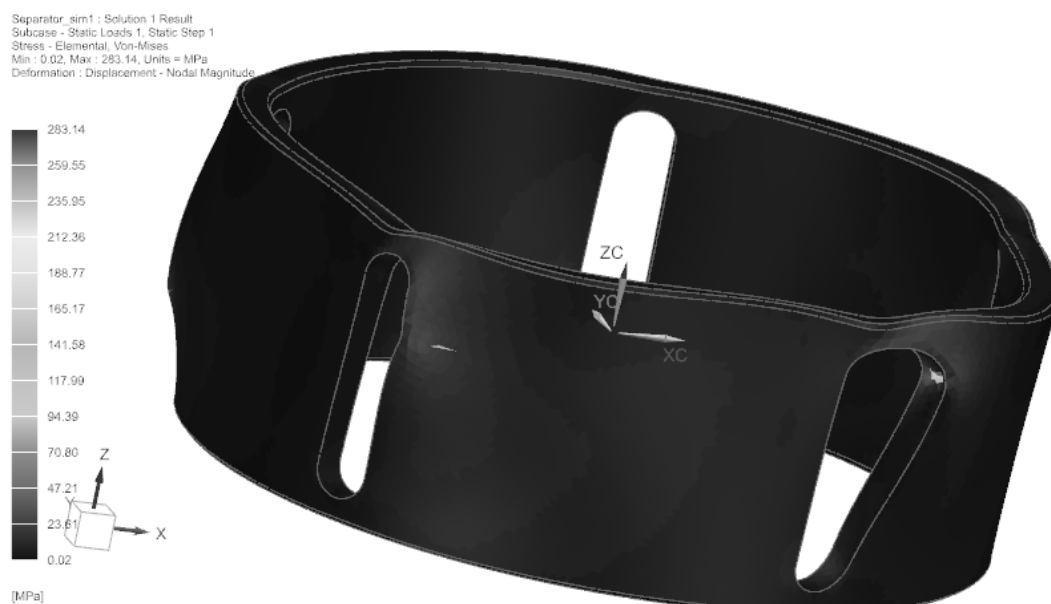
Рис. 5. Распределение напряжений в сепараторе
