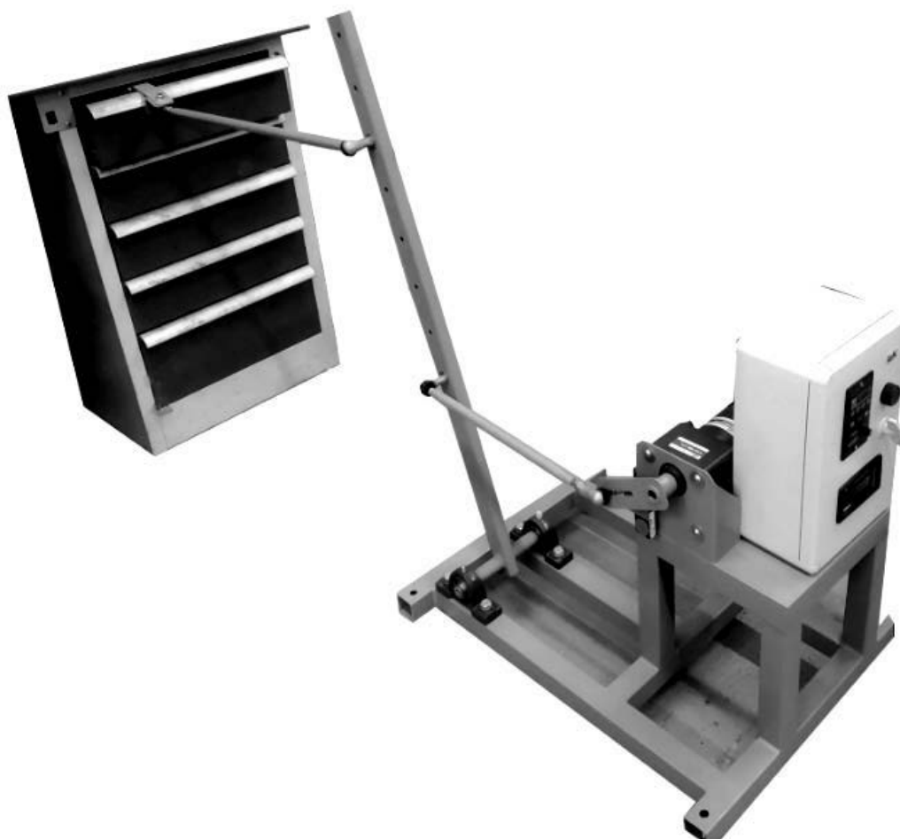
Рис. 7. Стенд проверки дверей и ящиков
