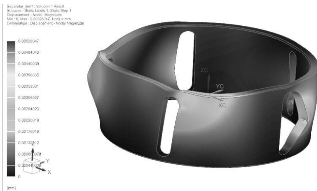
Рис. 4. Распределение деформаций в сепараторе
