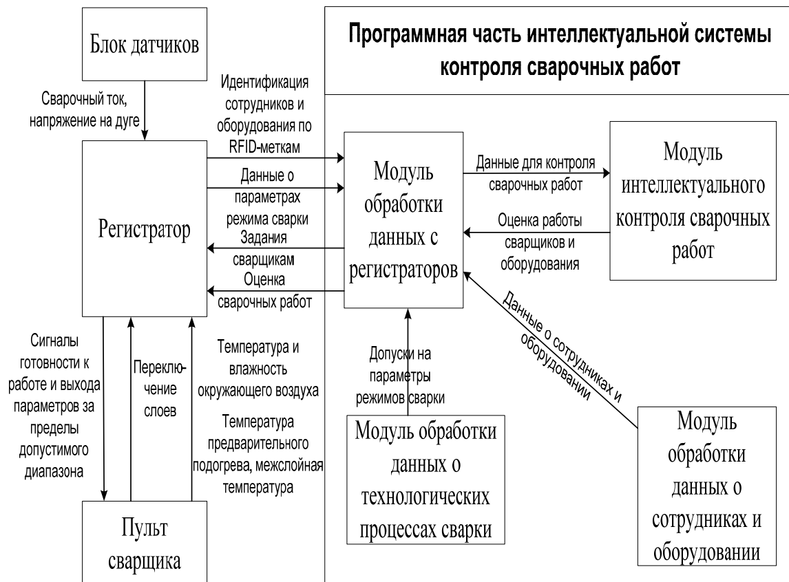
Рис. 1. Структура автоматизированной системы контроля качества дуговой сварки
