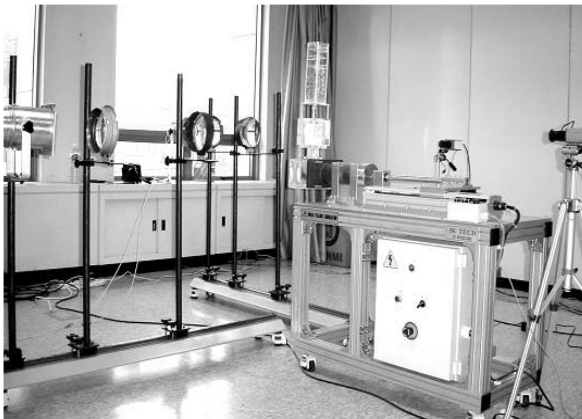
Рис. 1. Установка для водного аналогового моделирования процессов литья под давлением
