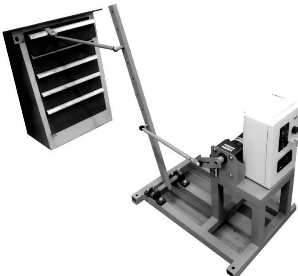
Рис. 7. Стенд проверки дверей и ящиков
