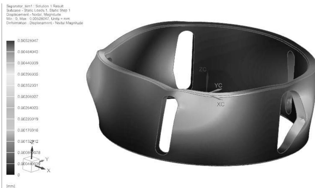
Рис. 4. Распределение деформаций в сепараторе
