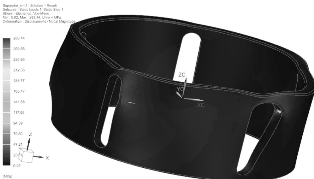
Рис. 5. Распределение напряжений в сепараторе
