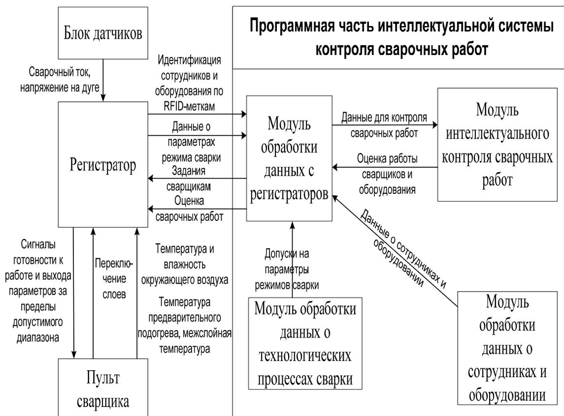
Рис. 1. Структура автоматизированной системы контроля качества дуговой сварки
