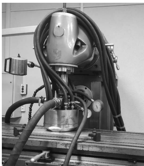
Рис. 1. Конструкция инструмента для упрочняющей обработки пневмоударом плоских поверхностей: 1 – полый вал; 2 – корпус; 3 – диск; 4 – лопатки; 5 – штуцер; 6 – приводящие шары; 7 – деформирующие шары; 8 – пневмоглушители; 9 – заготовка
