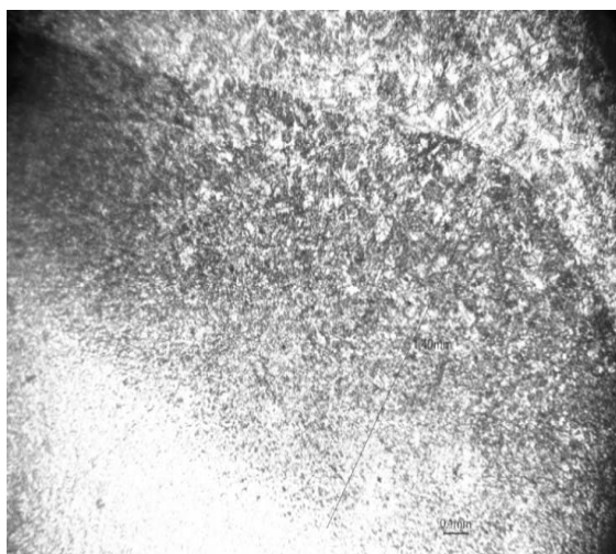
Рис. 9. Линия сплавления сварного соединения при времени \tau_{\text{св}} = 0,2 с, увеличение \times 640 : а – I_{\text{под}1} = 7,5 кА; б – I_{\text{под}2} = 9 кА
