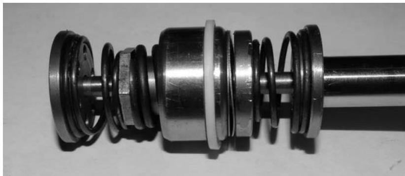
Рис. 2. Конструкция поршневого узла амортизатора в сборе
