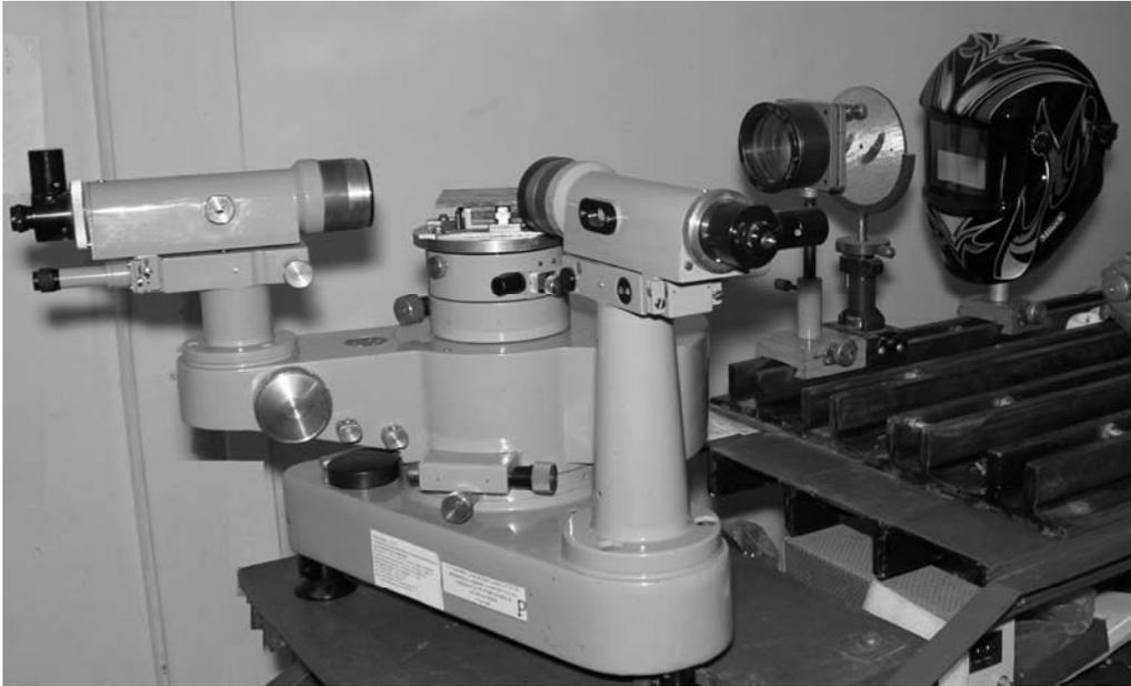
Рис. 5. Внешний вид установки для измерения разности призматического действия светофильтра
