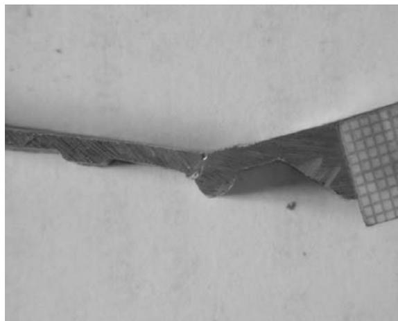
Рис. 5. Образец после испытаний на статическое растяжение
