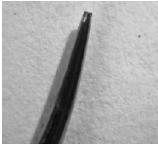
Рис. 4. Острие хирургической иглы (увеличение  $10\times$ ): *а* – в исходном состоянии; *б* – в затупленном состоянии
