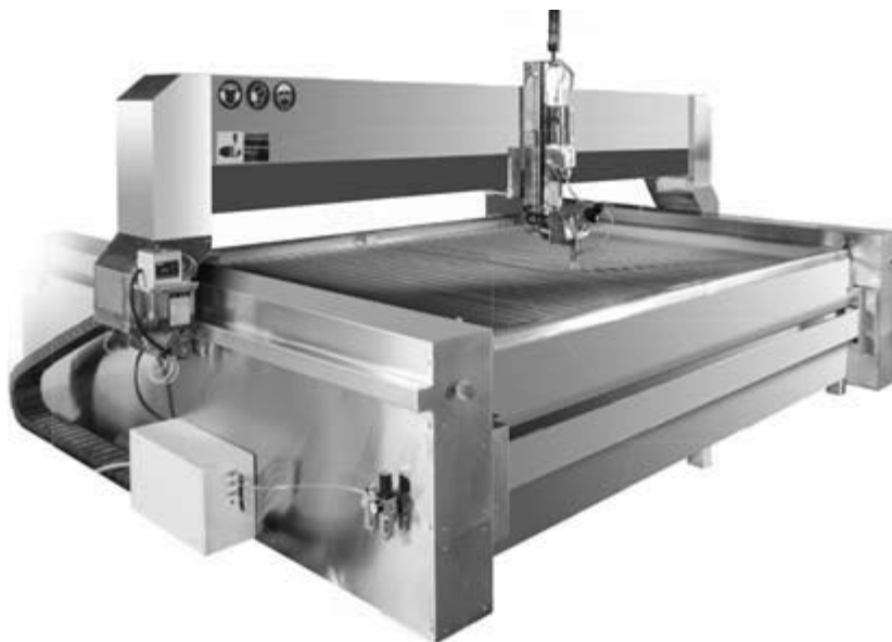
Рис. 3. Портальная установка гидроабразивной резки KNUTH Water-Jet 2060
