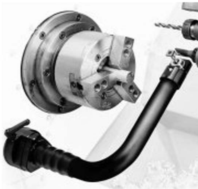
Рис. 6. Общий вид приспособления Renishaw серии HPR для наладки инструмента
