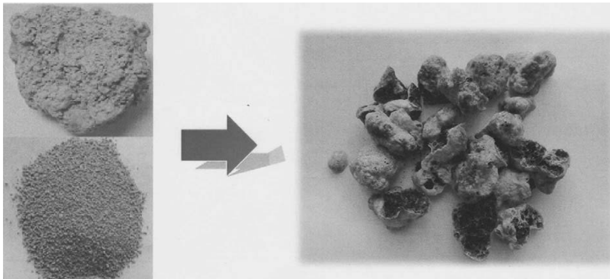
Рис. 2. Исходный продукт и конечный вид готовой пеностеклокерамики из белорусского трепела
