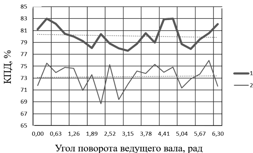
Рис. 6. Графики зависимости КПД передачи от конструкции составного ролика: 1 – с двухэлементным составным роликом; 2 – с трехэлементным составным роликом
