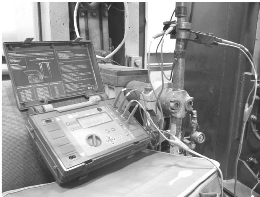
Рис. 2. Измерение активного сопротивления вторичного контура машины МТ-3201 цифровым микроомметром MMR-610
