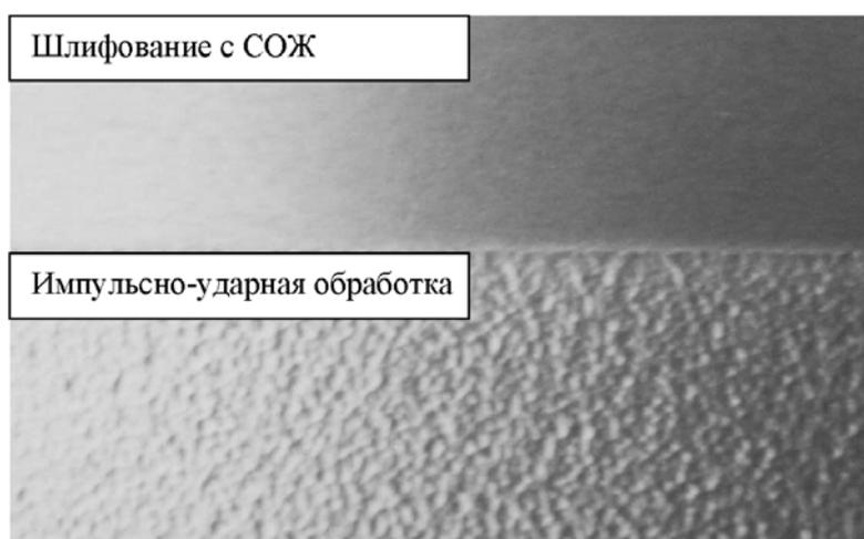
Рис. 1. Вид поверхностей после шлифования с СОЖ и после импульсно-ударной пневмовибродинамической обработки
