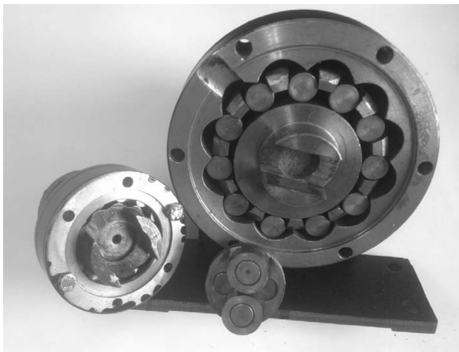
Рис. 5. Общий вид опытного образца двухступенчатого редуктора с промежуточными телами качения радиального типа во второй ступени
