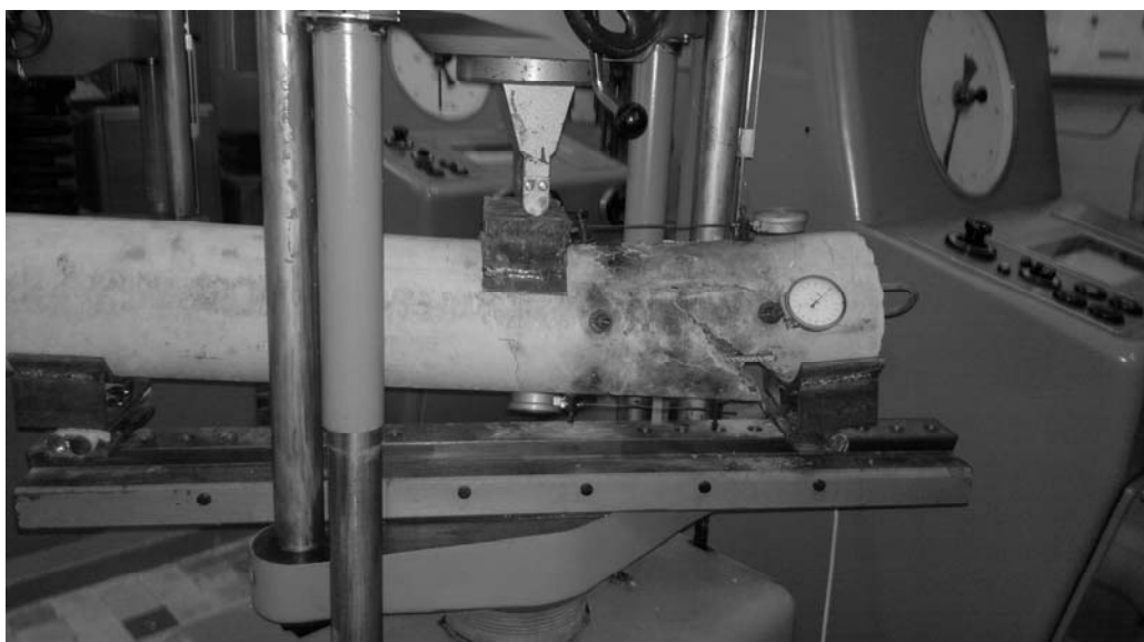
Рис. 1. Колонна круглого сечения после проведения испытаний
