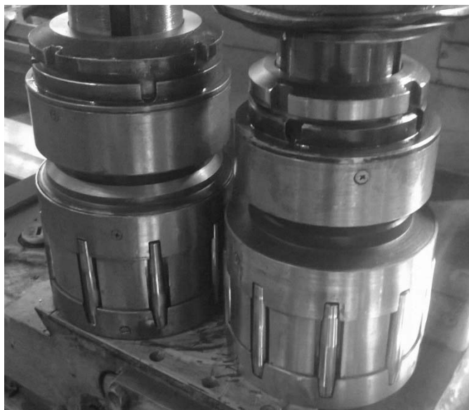
Рис. 5. Роликовые накатники, применяемые при изготовлении гильзы гидроцилиндра в филиале ОАО «БЕЛАЗ» – управляющей компании холдинга «БЕЛАЗ-ХОЛДИНГ» в г. Могилеве
