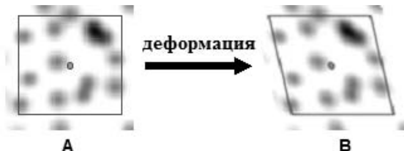
Рис. 2. Определение перемещения участка в деформированном изображении
