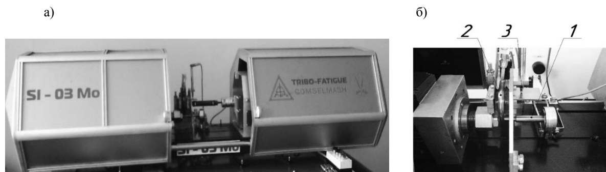
Рис. 3. Стенд для износоусталостных испытаний СИ-03-Мо: а – машина для износоусталостных испытаний; б – рабочая зона проведения испытаний
