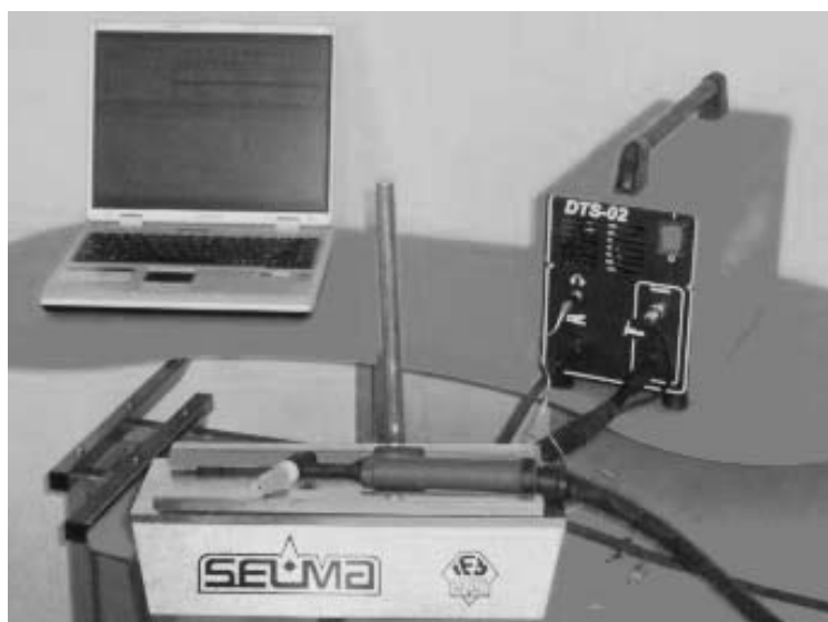
Рис. 3. Дуговой тренажёр сварщика ДТС-02
