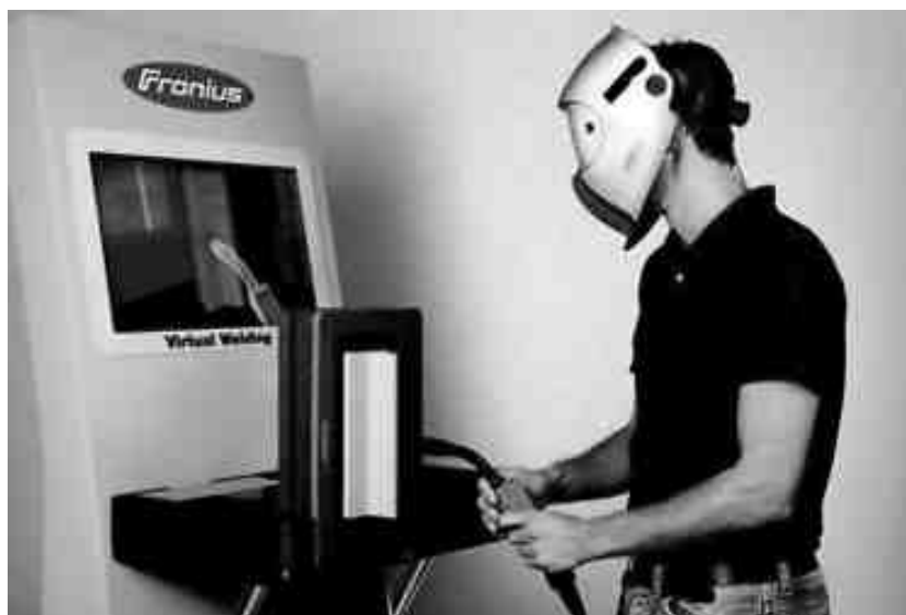
Рис. 1. Сварочный тренажер Fronius Virtual Welding
