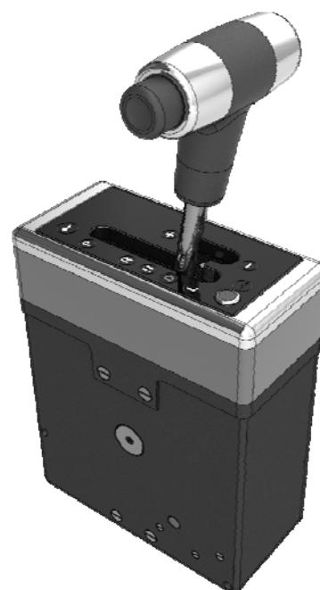
Рис. 4. Внешний вид контроллера (а) и селектора режимов управления ГМП (б)
