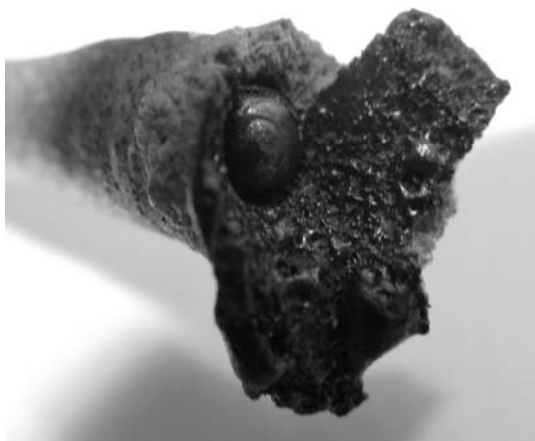
Рис. 1. Внешний вид оплавленной части сварочного электрода
