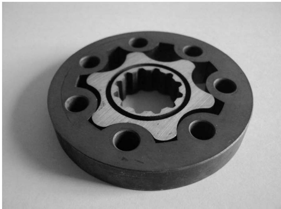
Рис. 1. Героторная пара насоса-дозатора сервосистемы гидрообъемного рулевого управления
