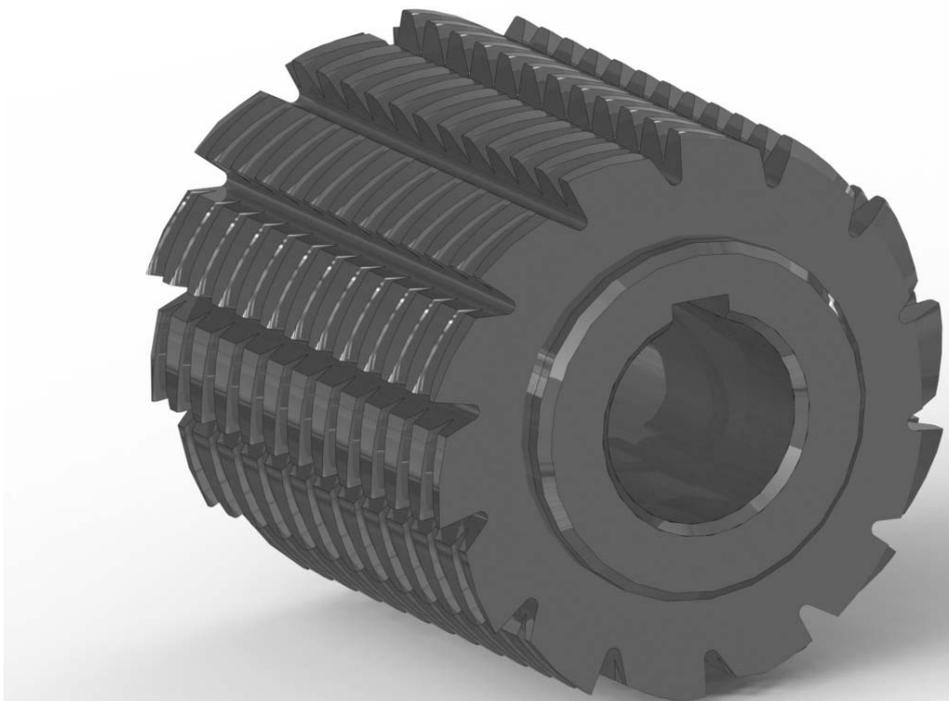
Рис. 8. 3D-модель специальной червячной фрезы
