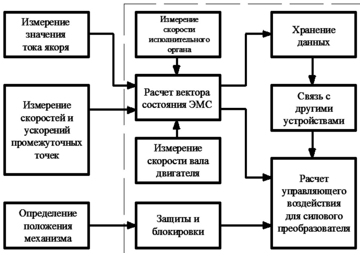
Рис. 1. Функциональная схема микропроцессорной системы
