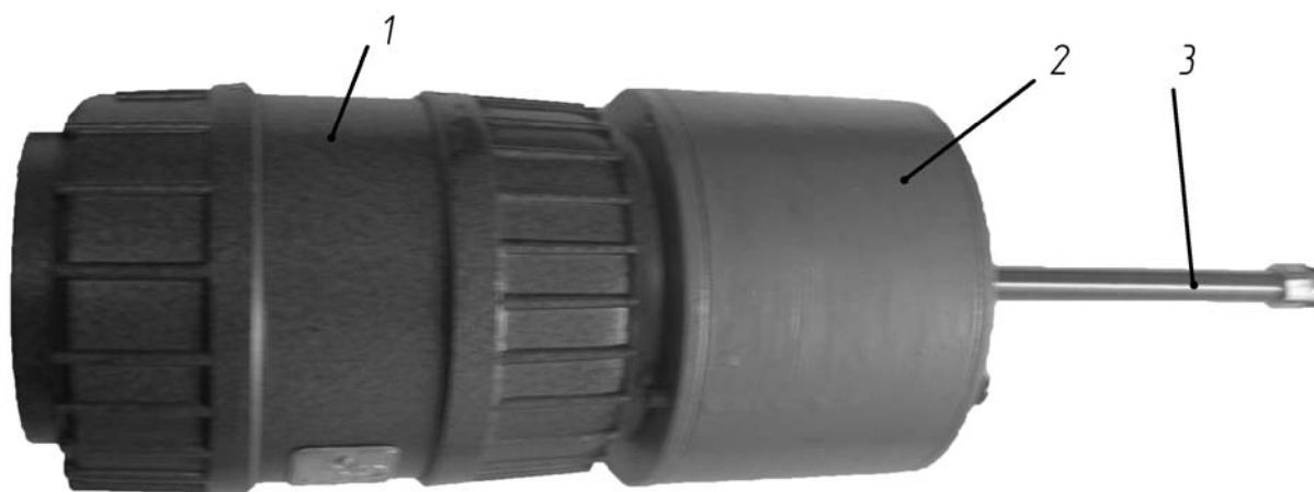
Рис. 4. Натурный образец прецессионного редуктора фрикционного типа с приводным электродвигателем: 1 — приводной электродвигатель; 2 — прецессионный редуктор фрикционного типа; 3 — гибкий выходной вал
