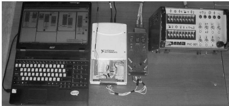
Рис. 3. Аппаратура системы автоматического управления процессом контактной рельефной сварки
