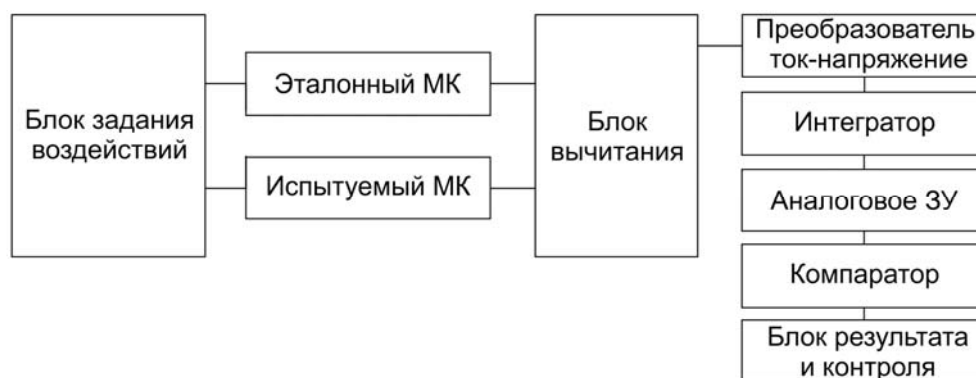
Рис. 4. Структурная схема устройства, реализующего функциональное тестирование микроконтроллера
