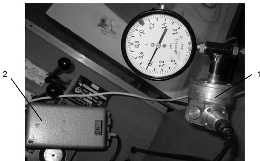
Рис. 6. Внешний вид МВОДД-01: 1 – первичный преобразователь; 2 – блок обработки сигнала
