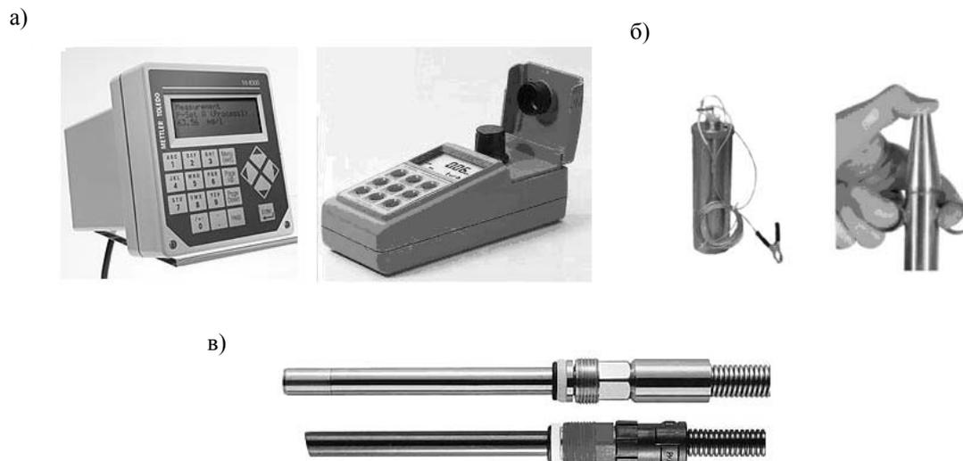
Рис. 1. Средства контроля мутности: а – турбидиметры; б – пробоотборники; в – волоконно-оптические датчики
