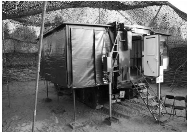
Рис. 1. Общий вид кузова-контейнера переменного объема
