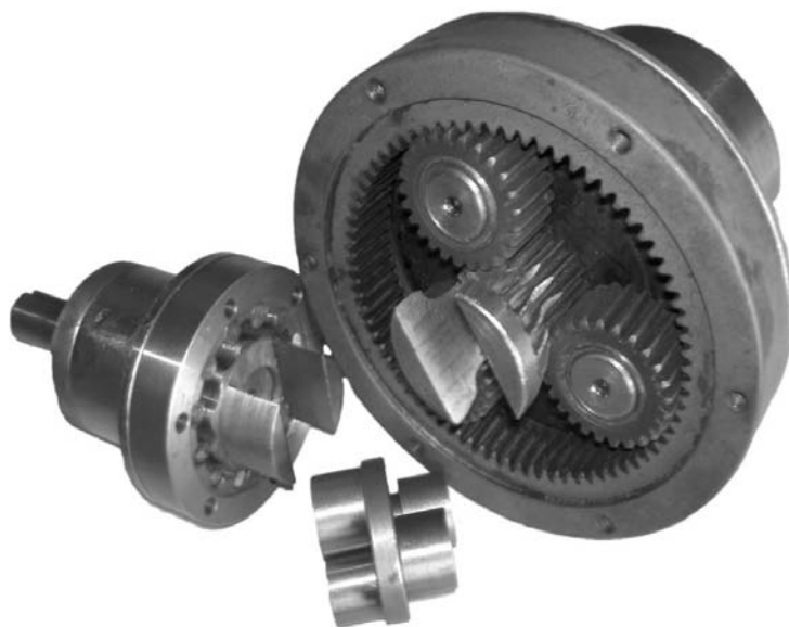
Рис. 8. Фотография опытного образца двухступенчатого планетарного механизма
