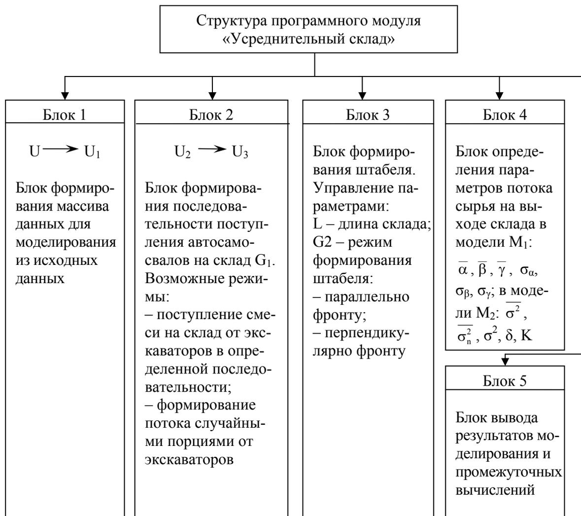
Рис. 3. Структура программного модуля «Модель усреднительного склада»
