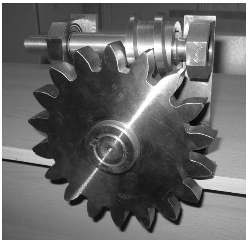
Рис. 5. Зацепление червяка с консольными зубьями колеса в собранном редукторе
