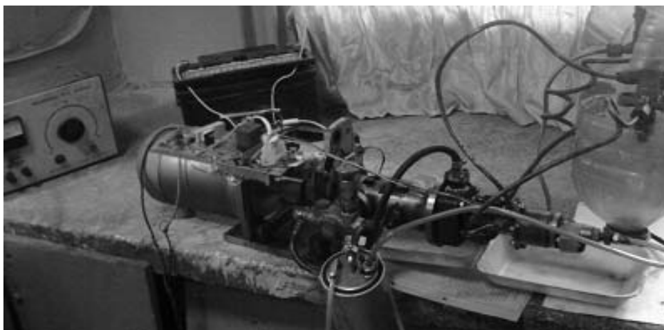
Рис. 4. Стенд для испытаний первого опытного образца ТНВД
