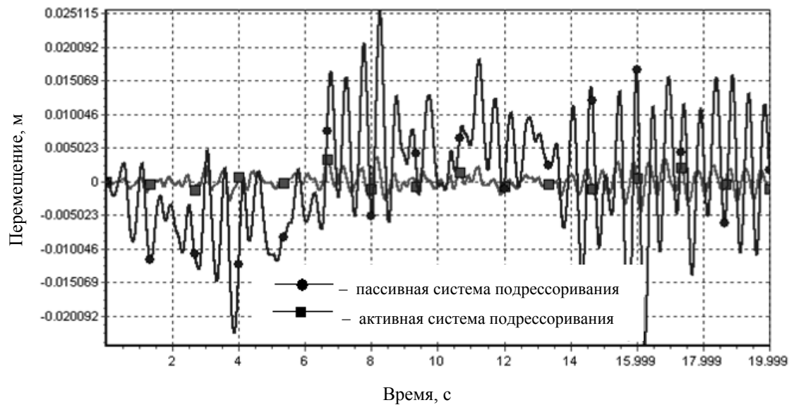
Рис. 9. Графики вертикальных колебаний центра масс шасси машины
