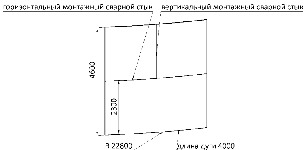
Рис. 3. Параметрическая модель типового исполнения (мат. модель 1)
