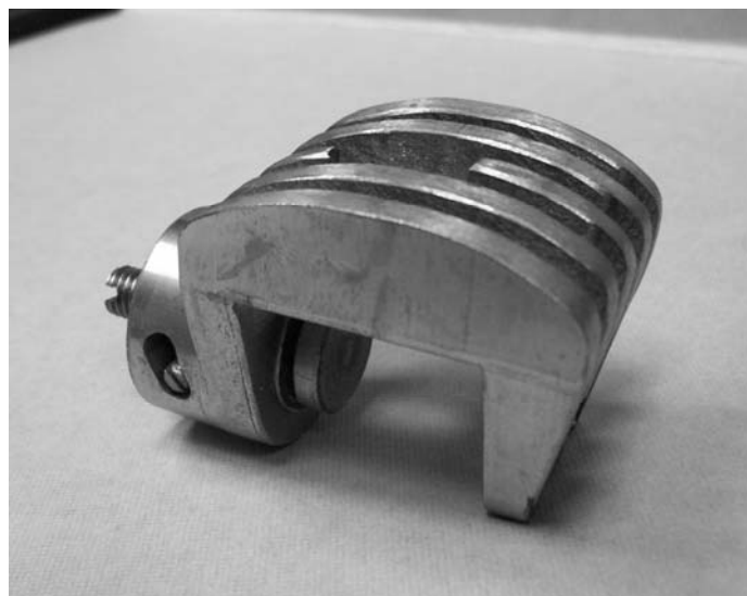
Рис. 7. Усовершенствованная скоба дискового тормоза с механическим приводом
