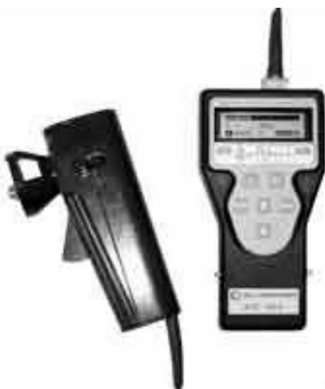
Рис. 1. Электронный измеритель прочности бетона ИПС-МГ4.01
