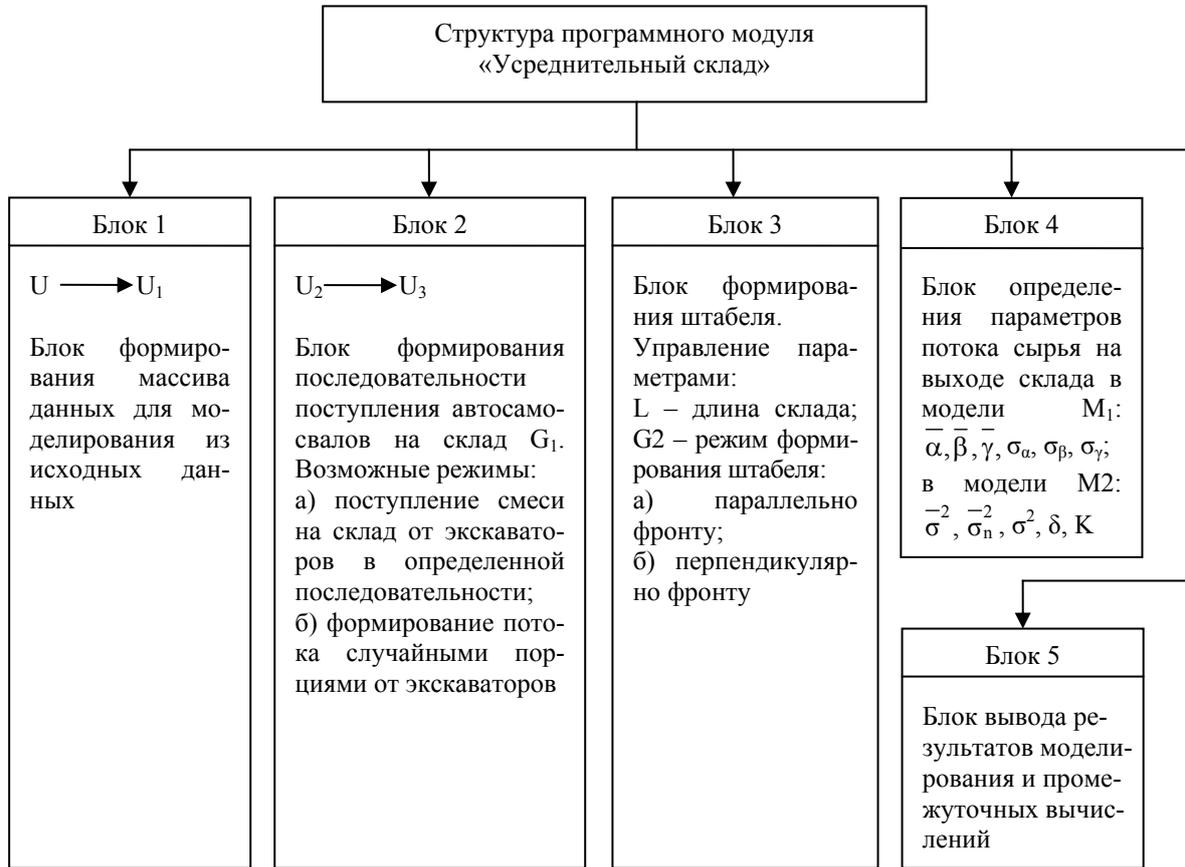
Рис. 2. Структура программного модуля «Модель усреднительного склада»
