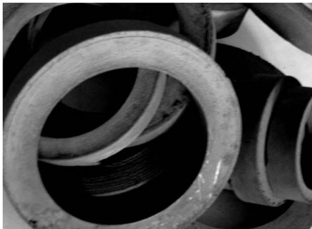
Рис. 1. Кольца волочильных машин с металлокерамическим покрытием
