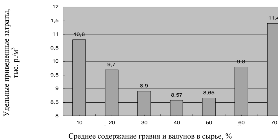
Рис. 2. Зависимость удельных приведенных затрат от среднего содержания фракций гравия и валунов по ДСЗ «Дубровка» Могилевской области
