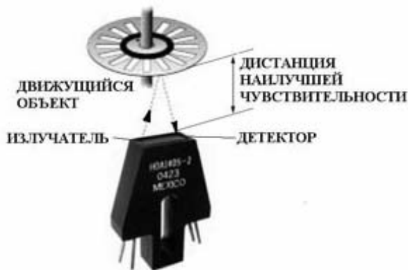
Рис. 3. Принцип работы оптического датчика скорости, работающего по методу отражения
