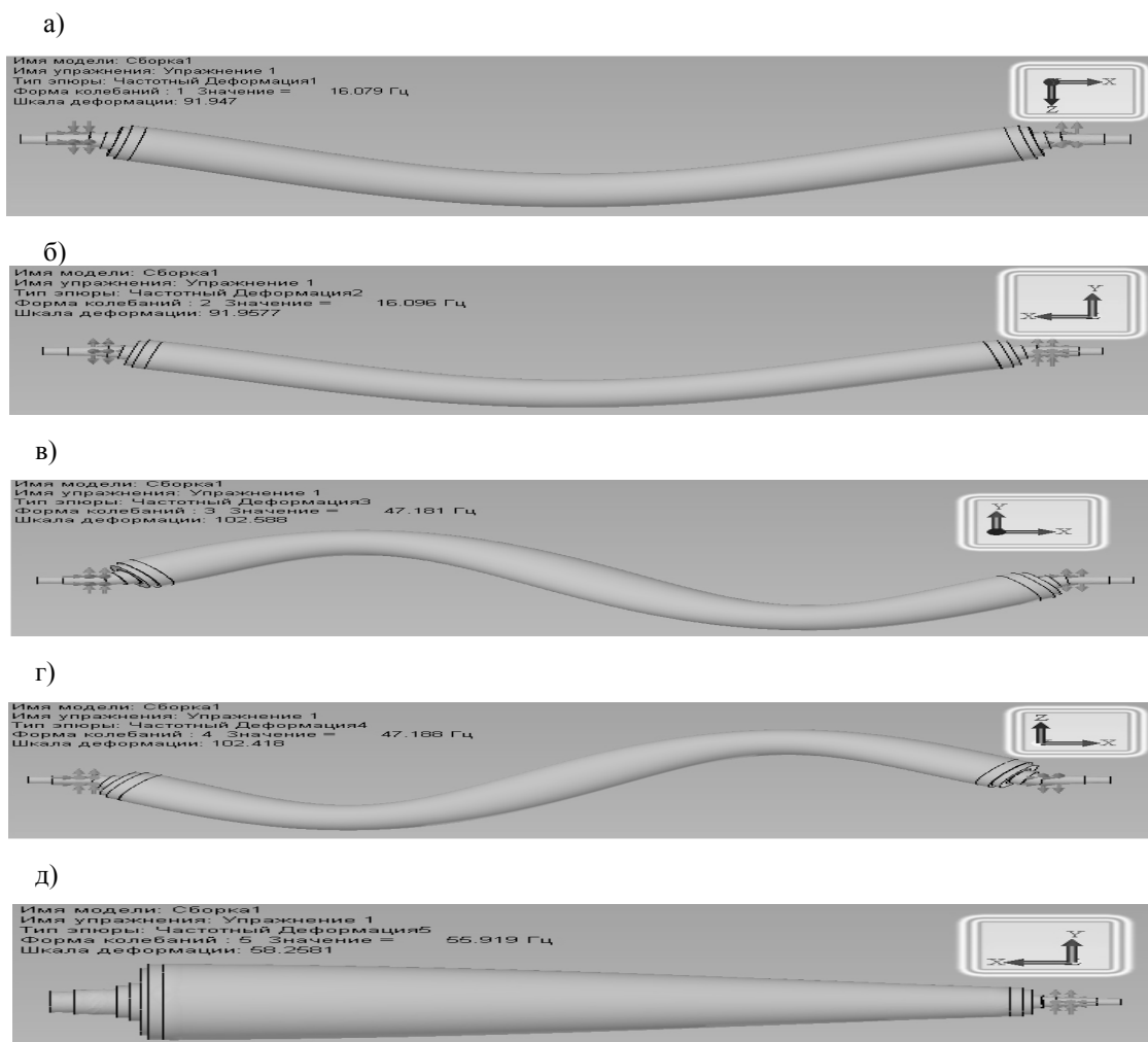
Рис. 4. Формы продольных и поперечных колебаний конечно-элементной модели НБВС формата 8620 мм
