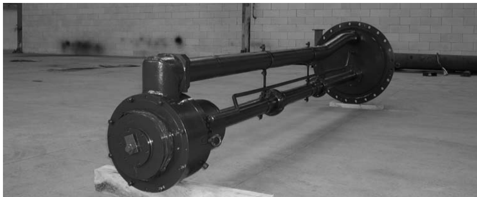
Рис. 6. Полупогружной агрегат ГДМП10-Е-200/100-90
