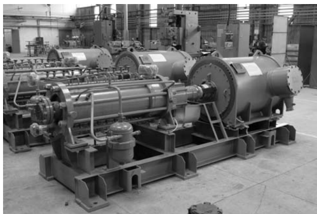
Рис. 5. Насосные агрегаты ГДМ8-03-125/700-400 для ОАО «Лукойл-Пермь»
