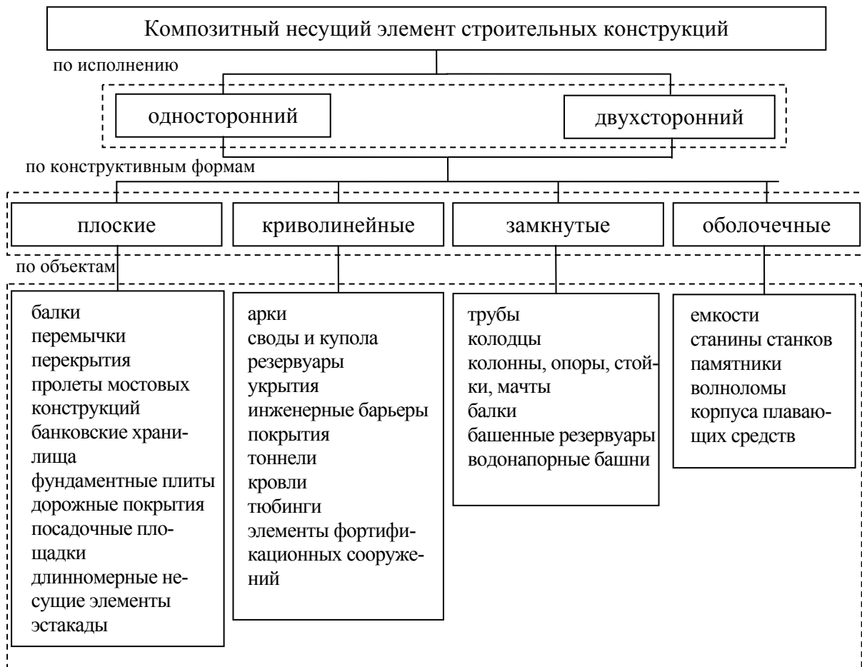
Рис. 2. Конструкции композитных несущих элементов строительных конструкций
