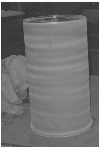
Рис. 10. Деталь с напыленным керамическим покрытием
