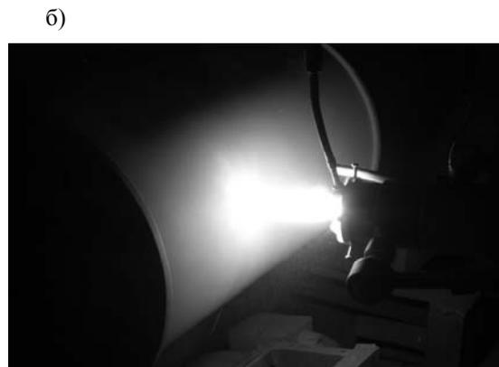
Рис. 9. Напыление покрытий с пульсирующей (а) и обычной (б) подачей порошкового материала в дуговую плазму
