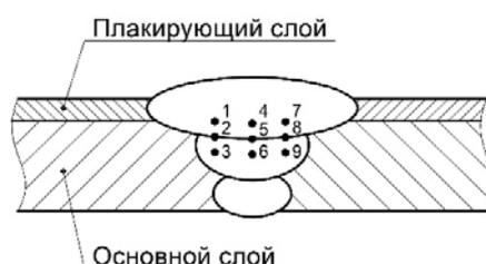
Рис. 6. Схема измерения микротвердости
