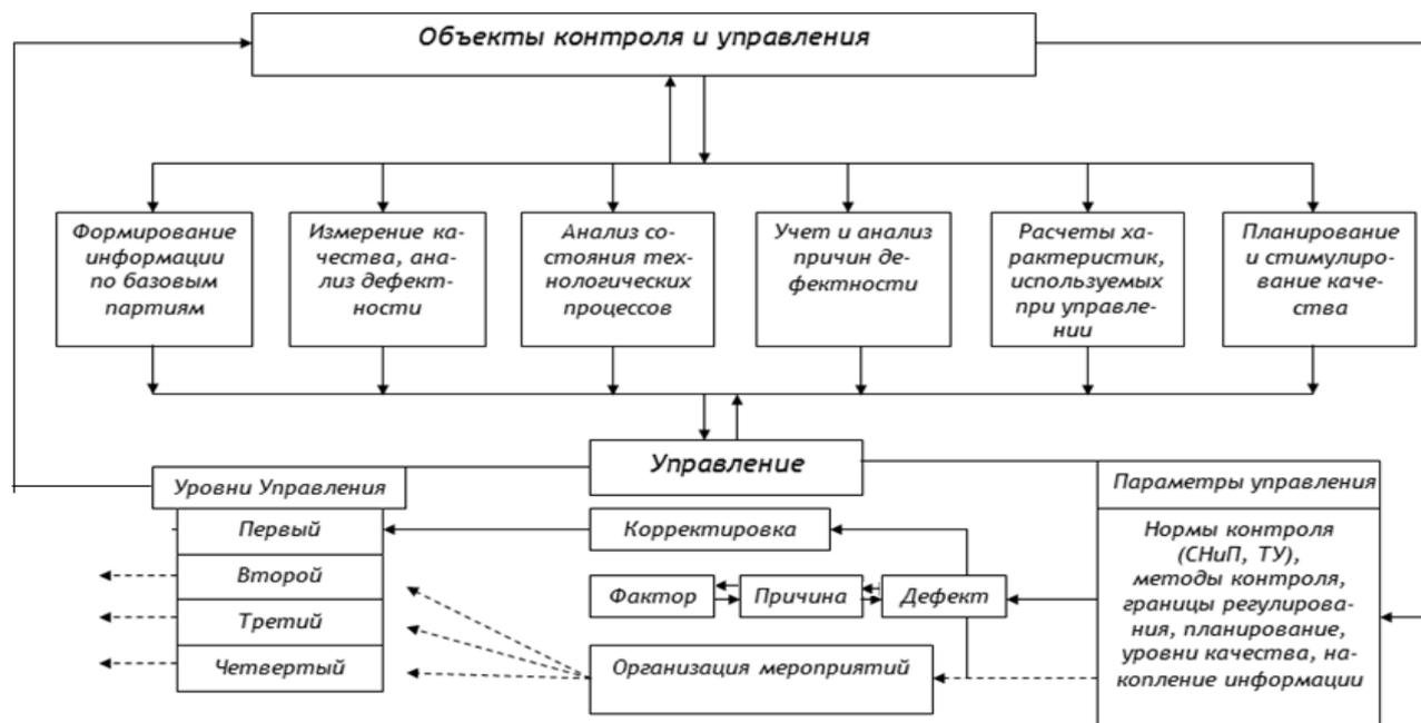
Рис. 1. Четырехуровневая система управления качеством сварочных работ
