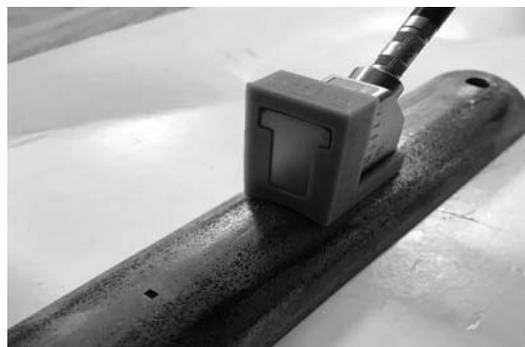
Рис. 2. Настройка ПЭП на трубном образце с зарубкой
