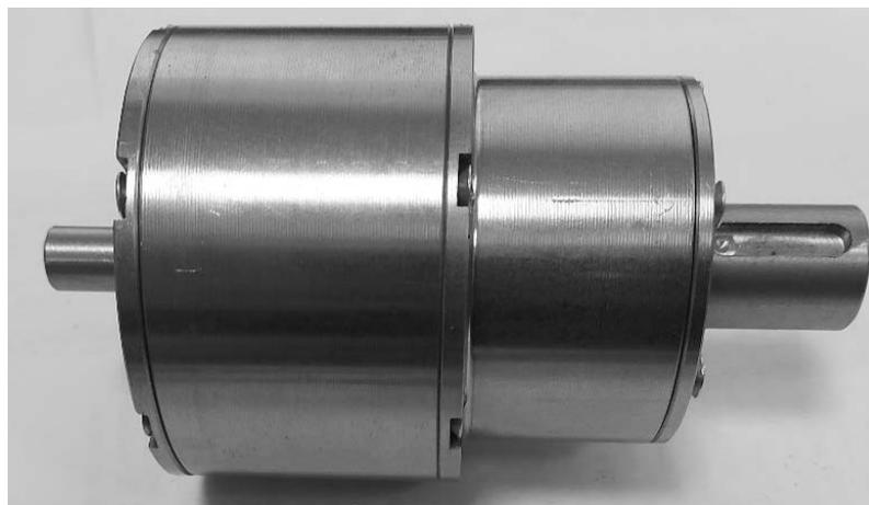
Рис. 2. Общий вид редуктора с СРП
