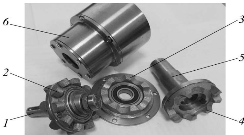
Рис. 1. Основные детали и узлы редуктора: 1 – ведущий вал; 2 – сателлит; 3 – неподвижное центральное колесо, соединенное с крышкой корпуса; 4 – ведомое центральное колесо, установленное на ведомом валу 5; 6 – корпус
