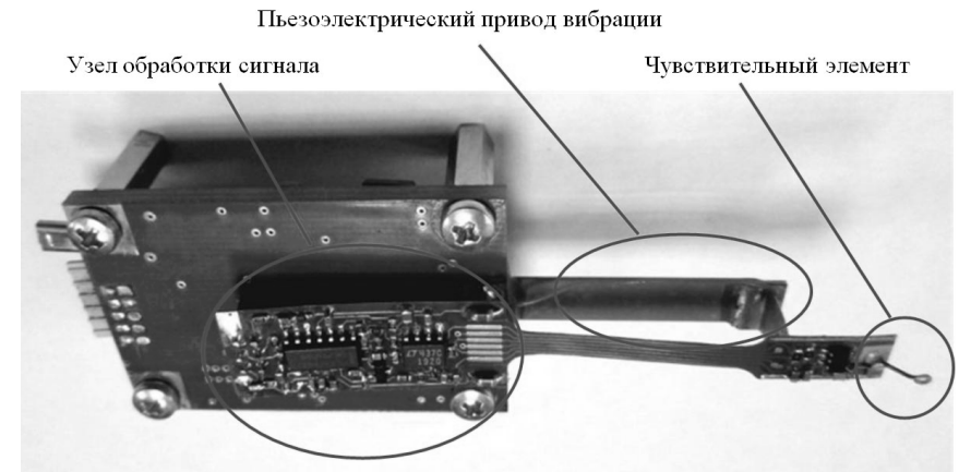
Рис. 1. Измерительный преобразователь, реализующий схему измерений КРП с неполной компенсацией сигнала чувствительного элемента
