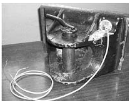
Рис. 4. Датчик измерения сил, включенный в сцепное устройство
