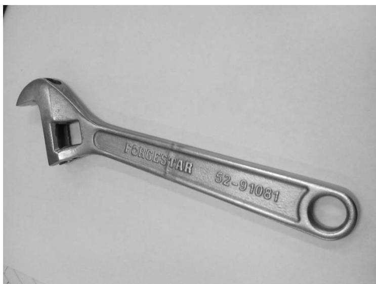
Рис. 1. Результат электрохимического полирования изделия из конструкционной легированной стали 40ХФА в электролите на основе органического растворителя
