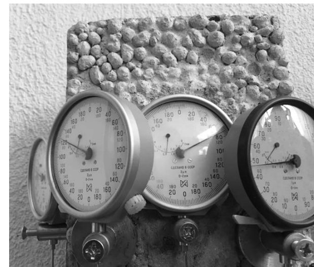
Рис. 1. Опытный образец для определения деформаций усадки керамзитожелезобетона
