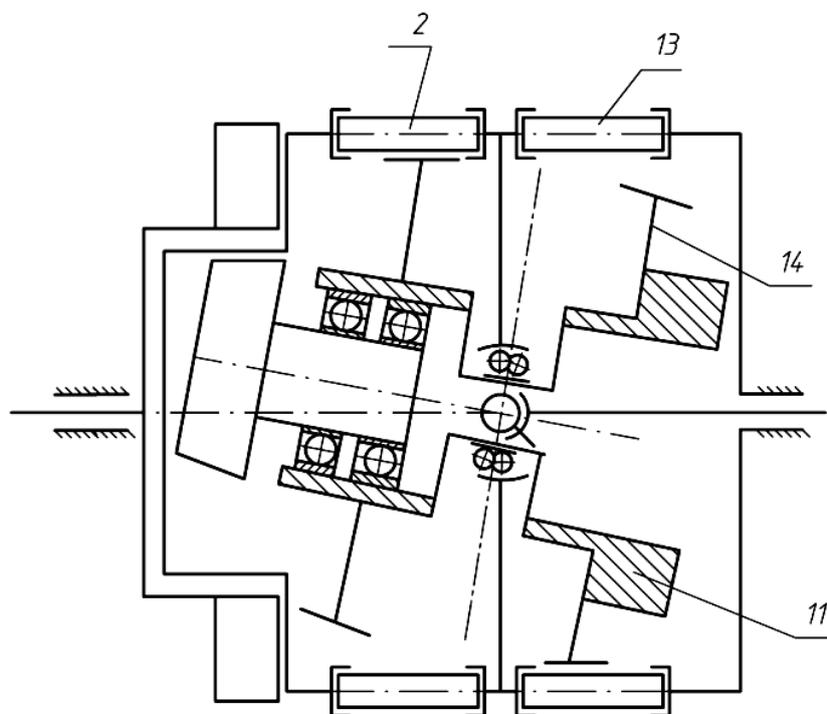
Рис. 4. Структурная схема магнитного привода с прецессионной передачей типа К-Н-В
