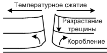
Рисунок 6 – Механизмы отраженного трещинообразования под действием температуры
