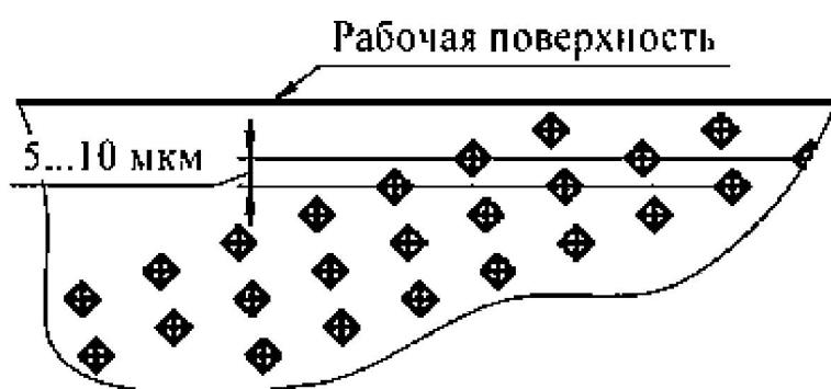
Рис. 1. Схема измерения микротвердости по глубине
