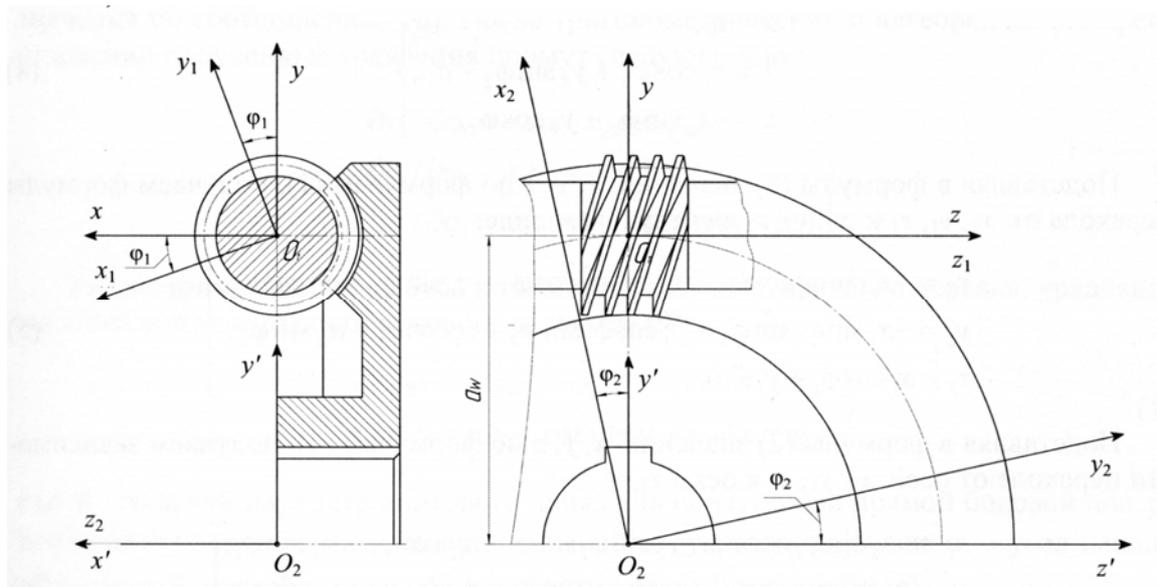
Рис. 5. Схема зацепления червяка с зубьями венца колеса двухвенцово́й червячной передачи
