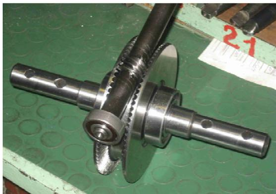
Рис. 4. Зацепление звеньев двухвенцовой червячной передачи культиватора
