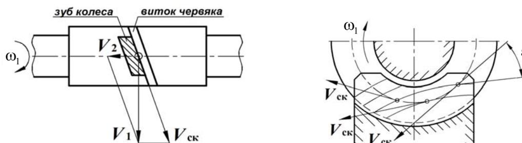
*Рис. 1. Скорости в червячном зацеплении и положение контактных линий относительно вектора скорости скольжения  $V_{ск}$  на зубе колеса ( $V_1$  и  $V_2$  – окружные скорости червяка и червячного колеса)*
