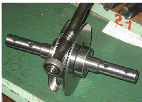
Рис. 4. Зацепление звеньев двухвенцовой червячной передачи культиватора
