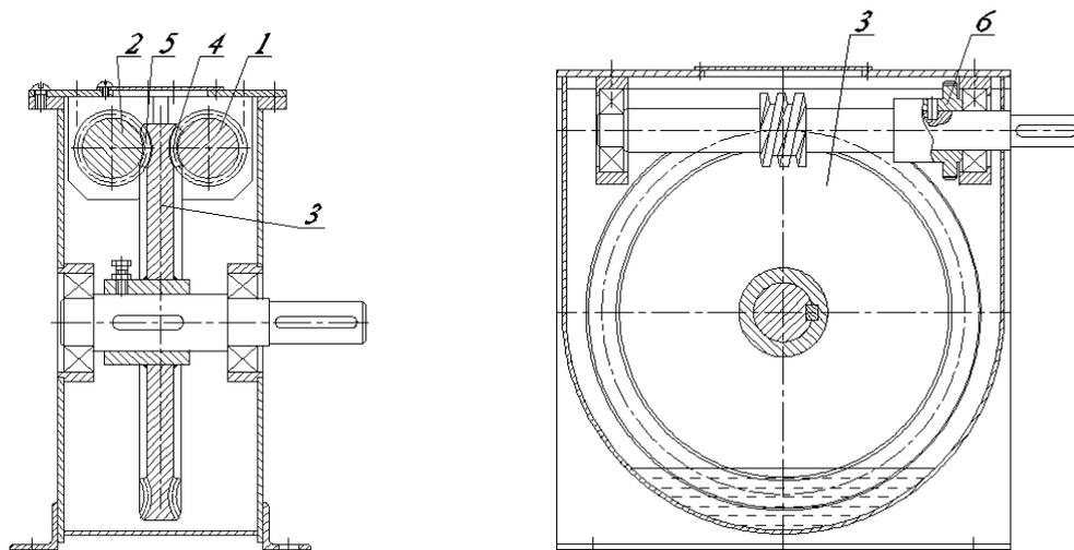
Рис. 3. Редуктор на основе двухвенцовой червячной передачи
