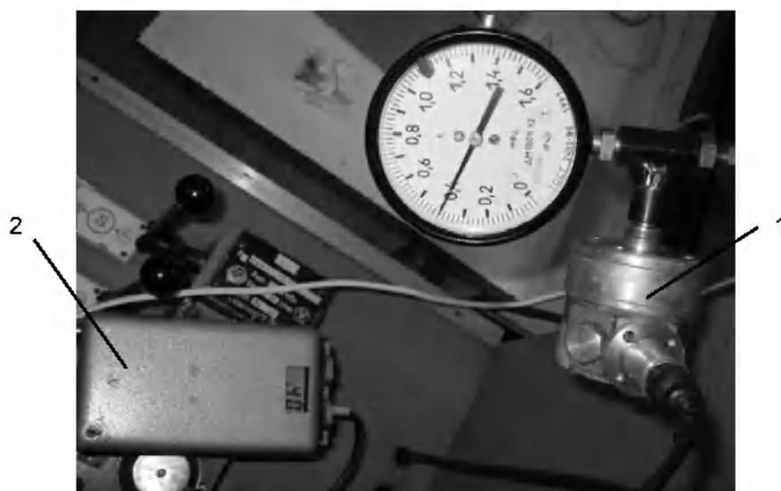
Рис. 6. Внешний вид МВОДД-01: 1 – первичный преобразователь; 2 – блок обработки сигнала
