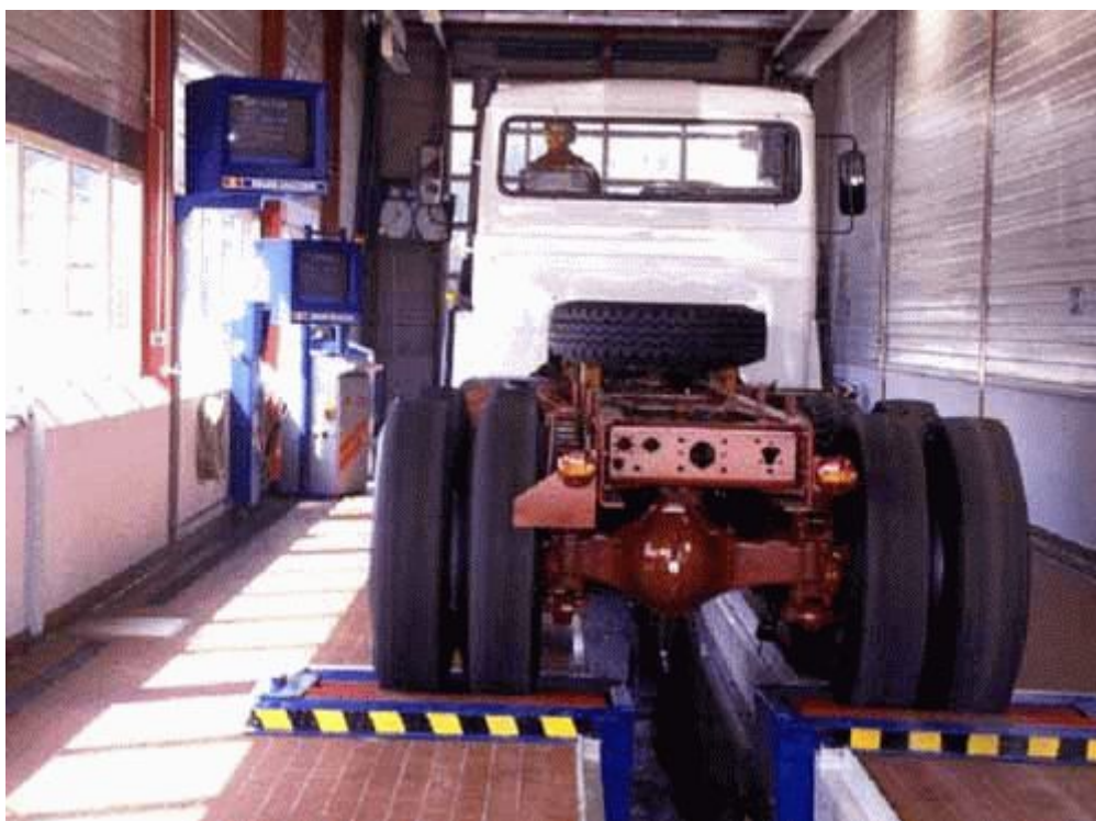
Рисунок 1 - Роликовый тормозной стенд для грузовых автомобилей с максимальной нагрузкой на ось до 18 т IW 7/E немецкой фирмы «МАНА»
