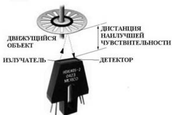
Рисунок 3 – Принцип работы оптического датчика скорости, работающего по методу отражения
