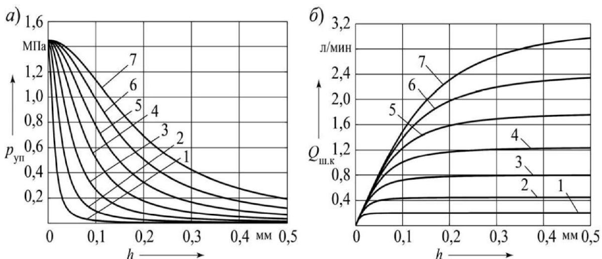
Рис. 4. Влияние диаметров дросселей на характеристики изменения управляемого давления  $p_{up}$  и расхода рабочей жидкости на слив  $Q_{mK}$ : 1 -  $d^s = 0,4$  мм; 2 -  $d^s = 0,6$  мм; 3 -  $d^s = 0,8$  мм; 4 -  $d_{dp} = 1,0$  мм; 5 -  $d_{dp} = 1,2$  мм; 6 -  $d_{dp} = 1,4$  мм; 7 -  $d_{dp} = 1,6$  мм
