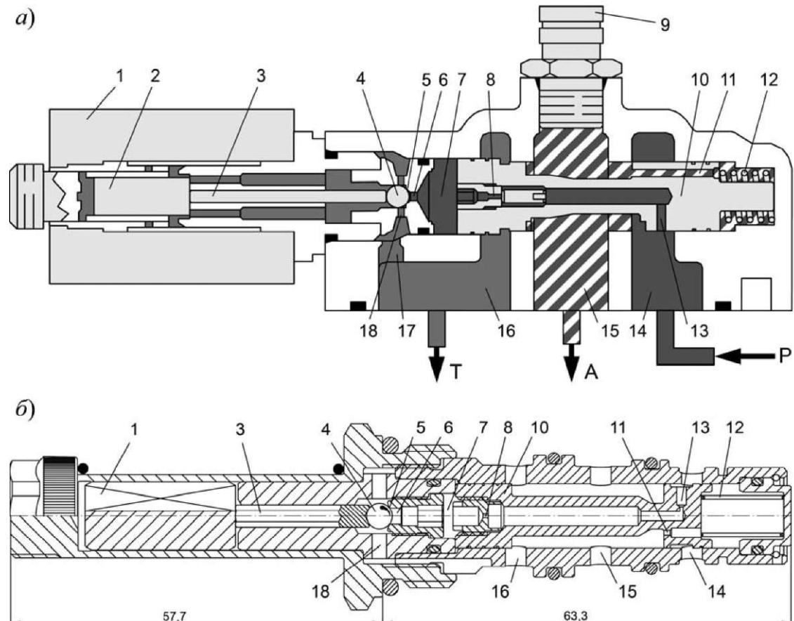
Рис. 2. Конструкции ЭГПК с шариковыми пилотными клапанами
