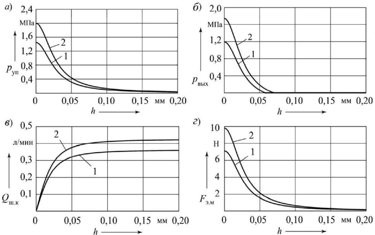
Рис. I. Характеристики шарикового пилотного клапана фирмы «Коматрол»: 1 - при  $p_{\text{гл}} = 1,41$  МПа; 2 - при  $p_{\text{гл}} = 2,0$  МПа
