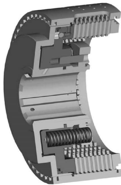
Рис. 2. Конструкция фрикциона ГМП с МСАУ
