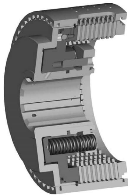
Рис. 2. Конструкция фрикциона ГМП с МСАУ
